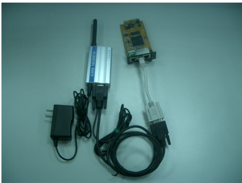
圖 2：GSM MODEM 組件安裝後之示意圖。如圖所示!
