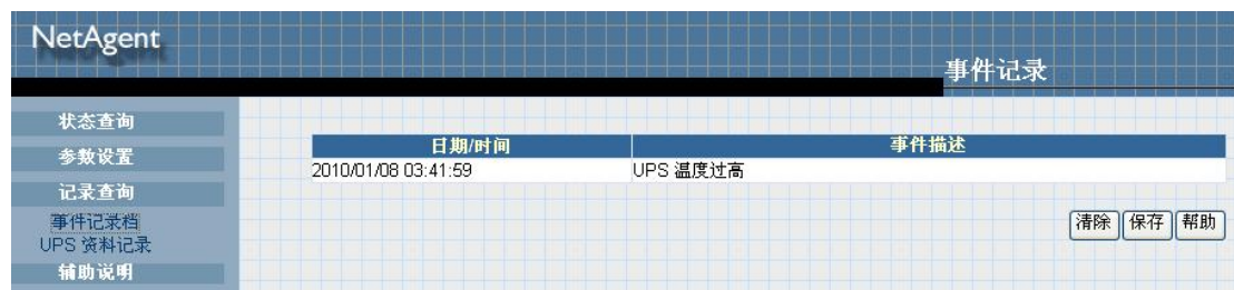
图 2: NetAgent 事件记录 显示发生 UPS 温度过高的信息记录。
